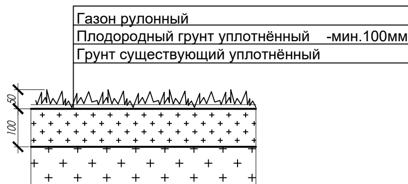
Схема устройства покрытия Г-1 Растительное покрытие Рулонный газон М 1:5
