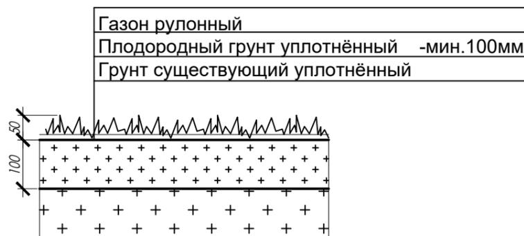
Схема устройства покрытия ПК-2, ПК-4
